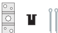
Supporto a stella, coppia e fermi. Star hole support, split pin and locks
