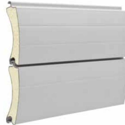
Profilo in acciaio curvo e rigato 19 x 77 mm., prodotto con l'impiego di lamiera rivestita in PVC.
