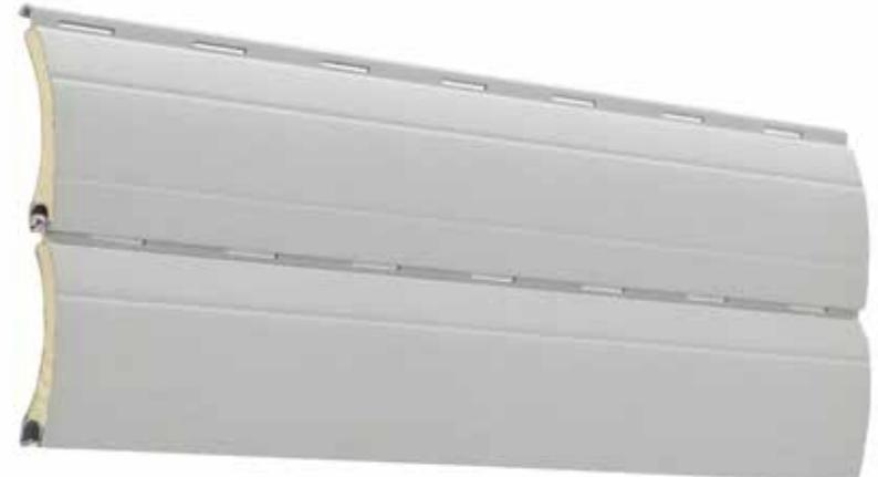
Profilo curvo e rigato, 7,5 x 37 mm. La sua principale caratteristica, pur trattandosi di un profilo con camera schiumata, è quella di avere un ingombro minimo tale da renderlo indicato per il sistema Box, agevolando in particolar modo l'impiego di cassonetti dalle dimensioni ridotte.
